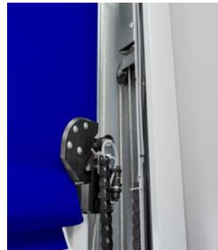
*Nach manueller Steuerbetätigung erfolgt die Abwärtsbewegung in die geschlossene Position. Alle Systeme regenerieren sich vollautomatisch: Torbehang und Schließkante werden über die Spannseile in die Zarge zurückgeführt, die Rastverbindungen bei Erreichen der Endlage wieder zusammengeführt.*
