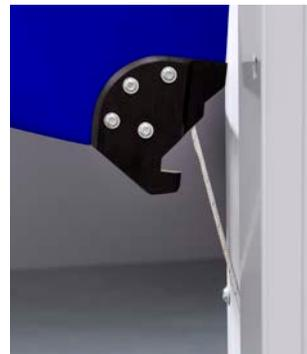
*Bei einer Kollision kann sich die Schließkante in alle Richtungen verformen. Vorgespannte Seile gewährleisten eine kontrollierte Auslenkung, bis sich auch die Rastverbindungen zwischen Torblattabschluss und Führungsstücken lösen. Richtungsunabhängig gleitet anschließend der Torbehang aus den Zargenführungen.*
