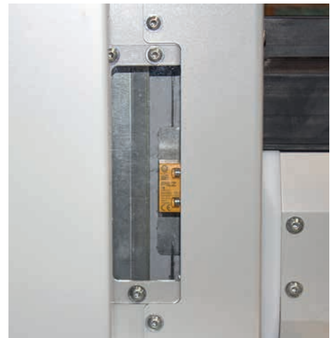
Zintegrowany wyłącznik krańcowy bezpieczeństwa
